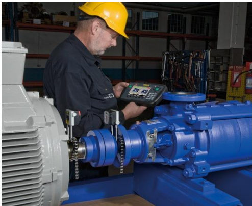
Phương pháp cân chỉnh bằng máy cân chỉnh đồng tâm đo bằng tia laser
