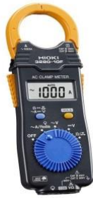
Ampe kìm dùng đo điện động lực nhà máy
