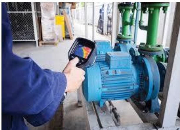
Đang dùng camera ảnh nhiệt đi quét tìm vị trí sự cố phát nóng động cơ
