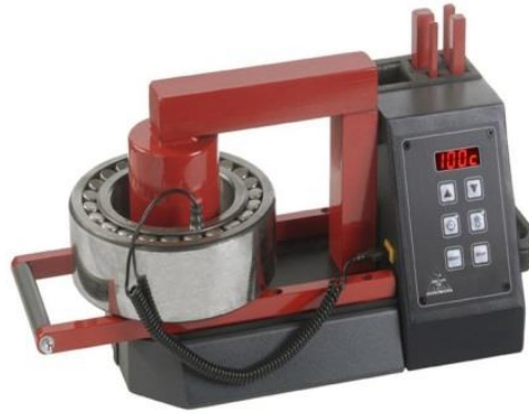
Dùng để làm nóng vòng bi để lắp vòng bi vào hệ thống truyền động
