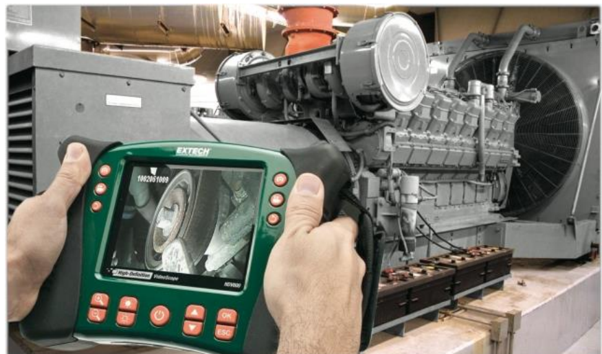
Máy nội soi công nghiệp dùng để quan sát các chi tiết không thể tiếp cận
