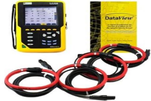
Dùng để phân tích công suất, sóng hài và giám sát mất ổn định, chất lượng điện
