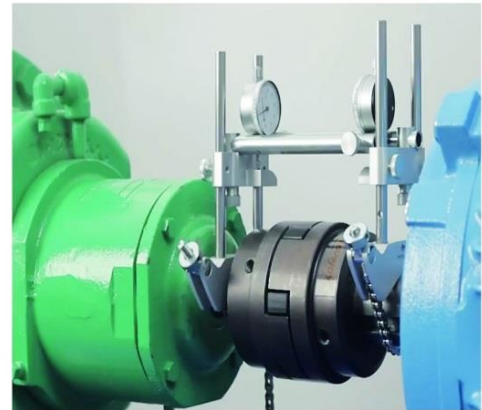
Phương pháp cân chỉnh truyền thống bằng đồng hồ so (cần nhiều kinh nghiệm và mất nhiều thời gian, chính xác thấp)
