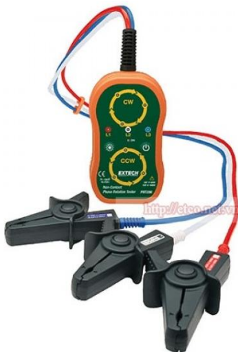
Đồng hồ đo thứ tự pha, dùng để xác định thứ tự pha để lắp động cơ có chiều quay động cơ đúng hướng
